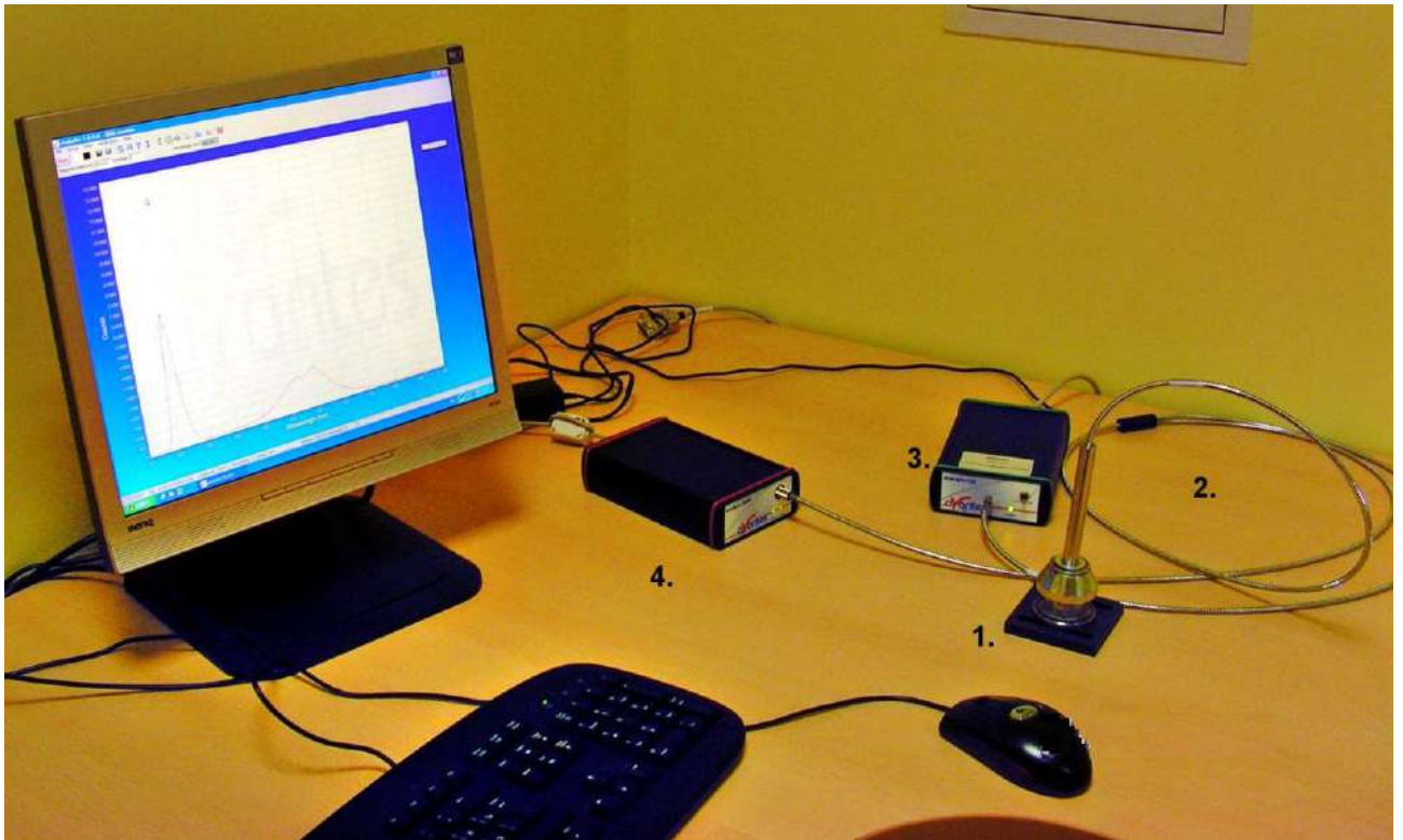
Pav.9. Holo Liuminescencijos spektrų matavimo eksperimento įrengimas.
