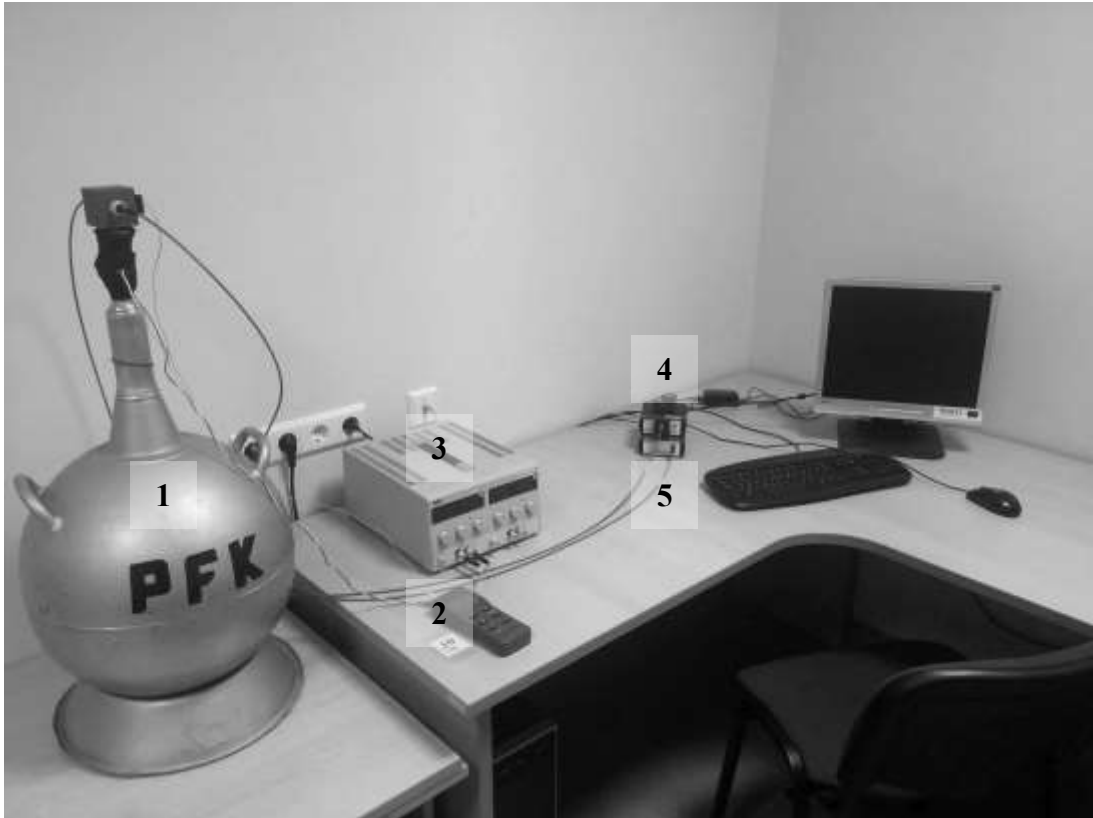
7 pav. Eksitonų tyrimo matavimo aparatūra
