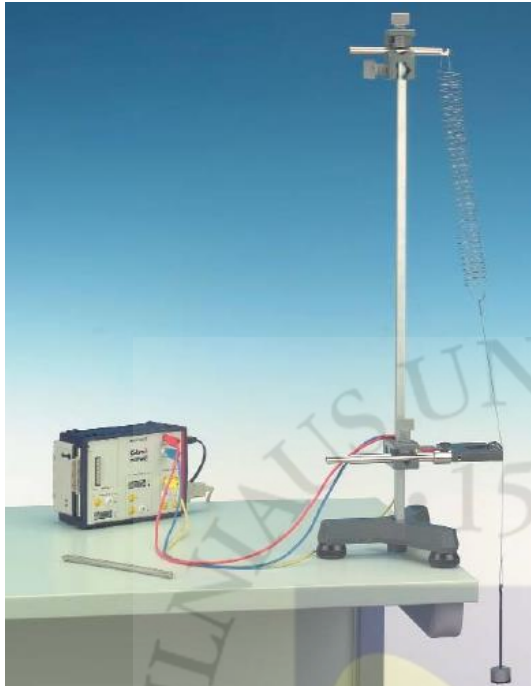
1 pav. Eksperimentinė įranga spyruoklės standumui matuoti.
