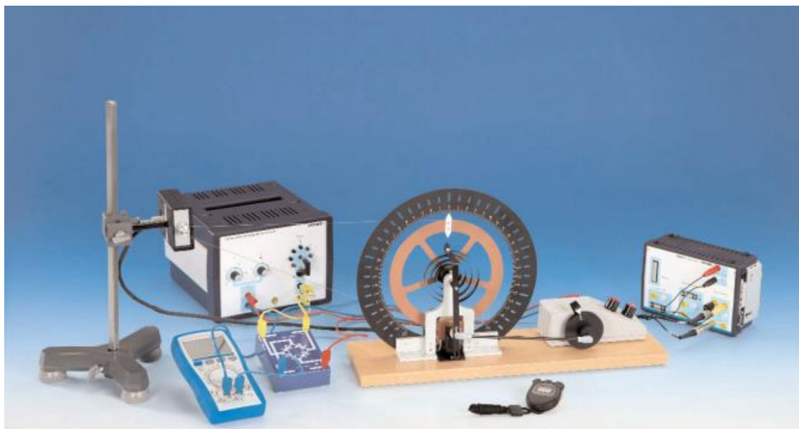
7 pav. Priemonės slopinamųjų ir priverstinių svyravimų tyrimui sukamąja Polio svyruokle.
