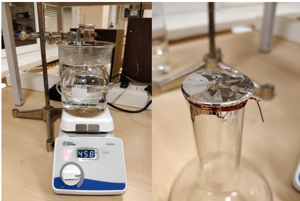
1 pav. Lakaus skysčio molinės masės matavimo standas.
